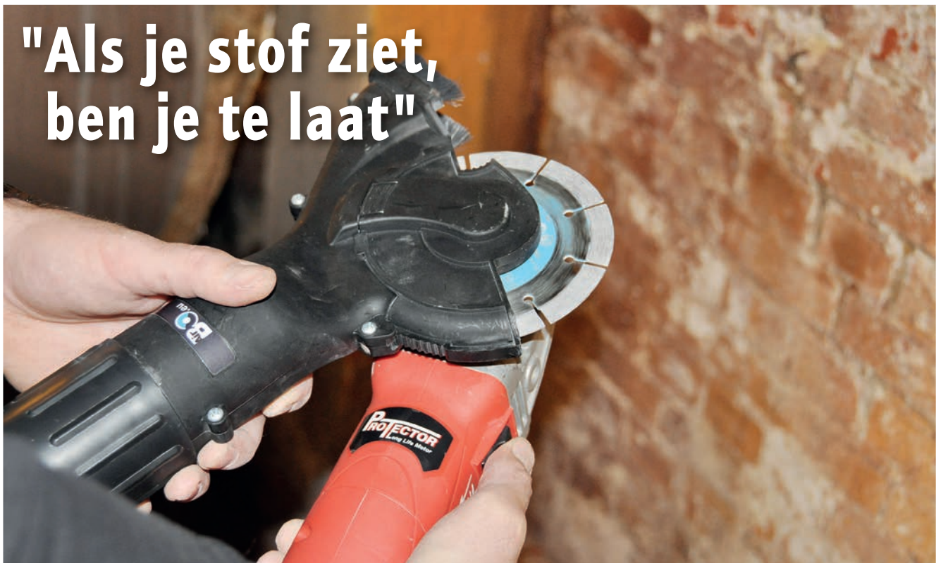
Airbo stofkap met slijpschijf.
