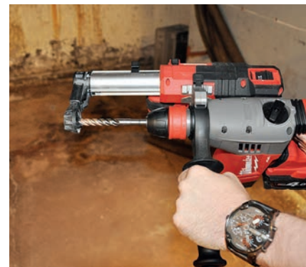
Hamerboormachine met afzuighulpstuk.
